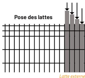
Tresser les lattes en fonction du type de pose. Penser à mettre les lattes externes à chaque extrémités. Les lattes doivent être tressées à chaque fils horizontaux.
